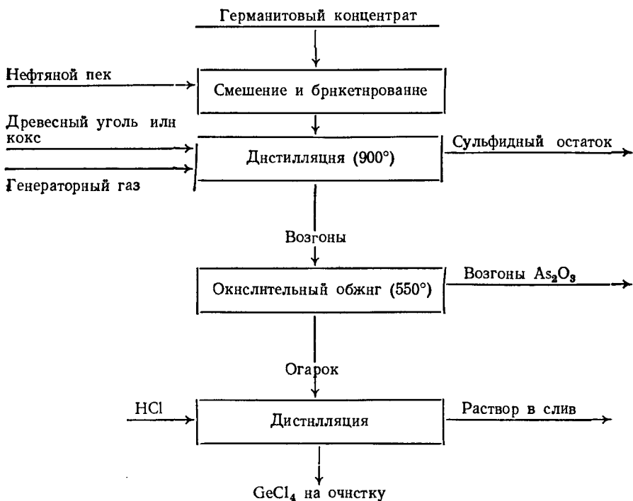
Рис. 47. Схема переработки германита
